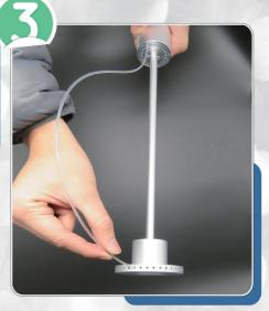
用同样的方法在相邻的位置插入一根光纤(短)。 USE THE SAME METHOD INSERT A FIBER OPTIC (SHORT) AT THE NEXT POSITION.
