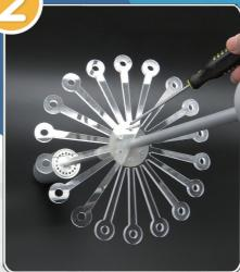
用同样的方法在相邻的位置插入 一根光纤(短)。 USE THE SAME METHOD INSERT A FIBER OPTIC (SHORT) AT THE NEXT
